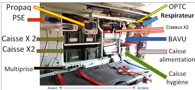
3. Secteur droit du VBCI aménagé
