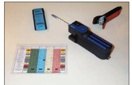
Figure 4. Tubes colorimétriques Dräger.
